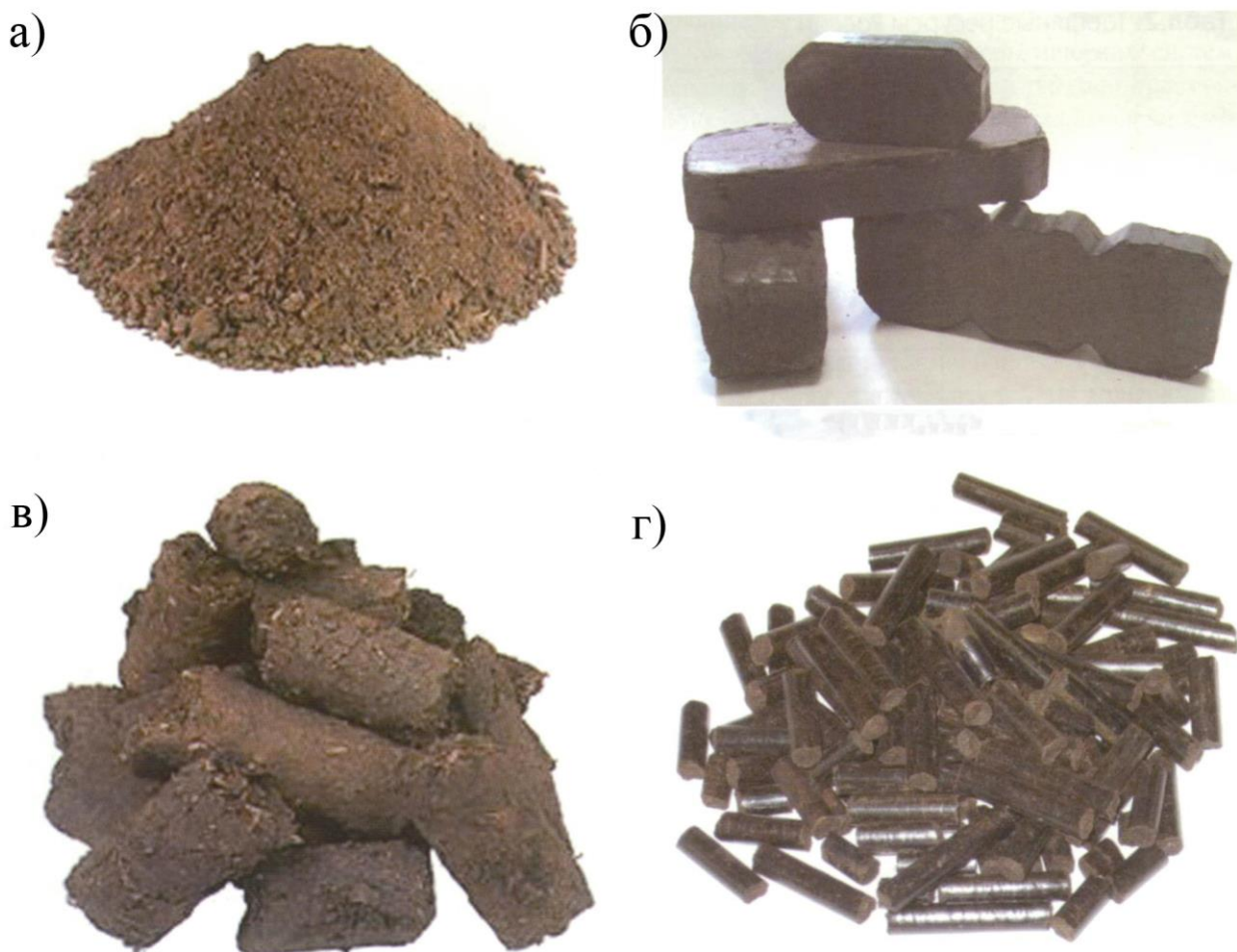
Рисунок 5.1 – Образцы топливного торфа: а) фрезерный топливный торф; б) торфяные топливные брикеты; в) кусковый топливный торф; г) гранулированный торф(пелеты)
